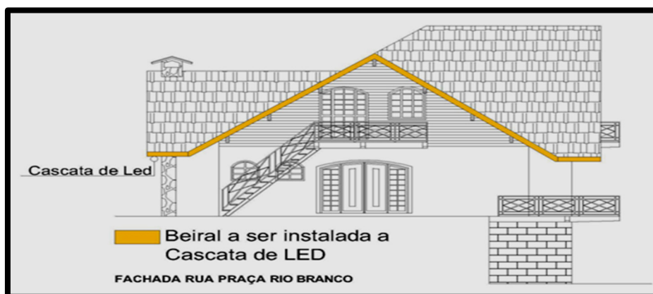
Figura 1 - Localização dos beirais de instalação da Cascata de Led na Fachada para a Rua Praça Rio Branco
