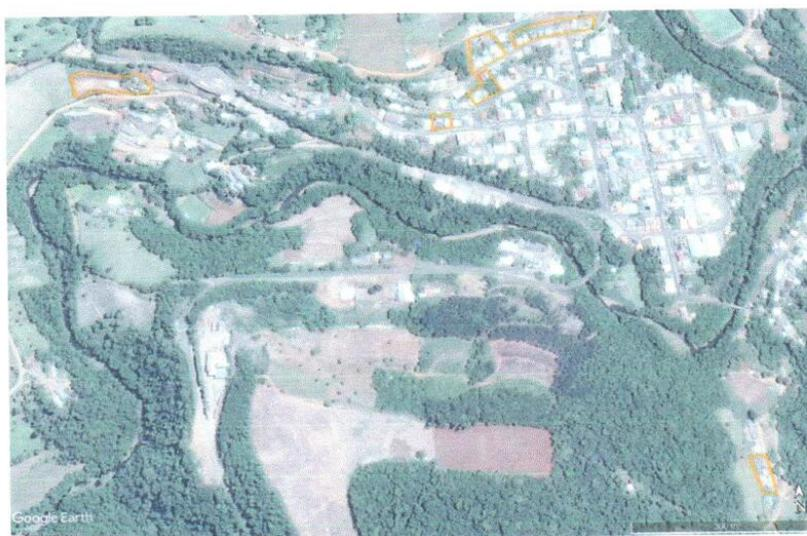
Figura 4. Setores com risco geológico do município de Xavantina. Seis Setores com Risco Alto em laranja. Não há setores de Risco Muito Alto no município. (Imagem: Google Earth).
