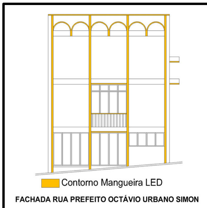
Figura 37 - Contorno com Mangueira de Led, na Fachada Frontal para a Rua Prefeito Octávio Urbano Simon
