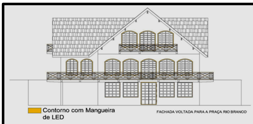
Figura 7 - Contorno com Mangueira de Led, na Fachada voltada para a Praça Rio Branco
